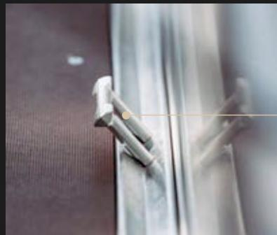
Poignées de fixation intégrées dans le plancher – à l'avant, à l'arrière et sur les côtés.
