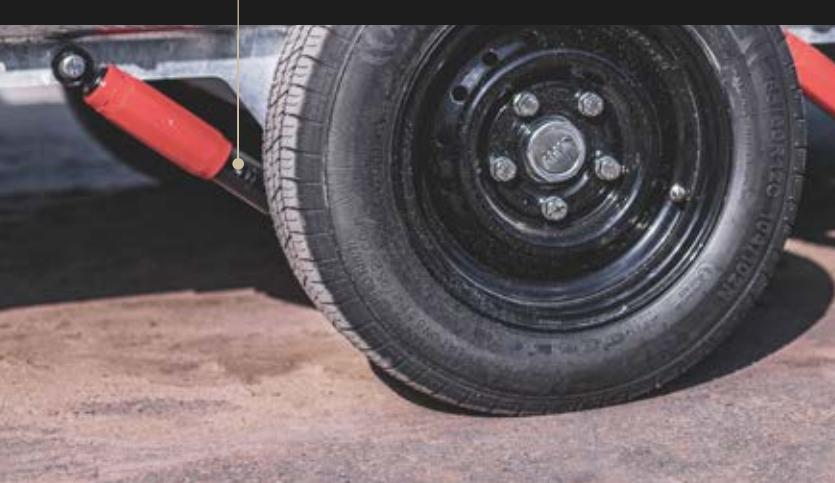
En option, des amortisseurs améliorant le confort de conduite, la sécurité et la stabilité – ils réduisent les vibrations et les secousses.
